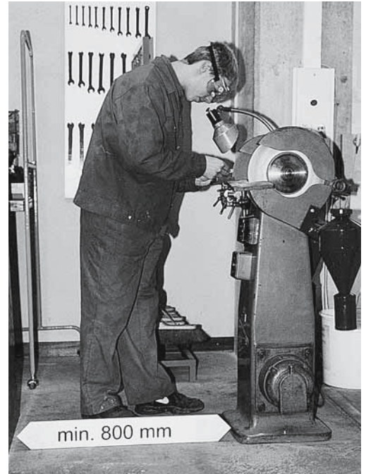
Fig. 1: prevedere uno spazio libero di almeno 0,8 m per poter lavorare in sicurezza.
